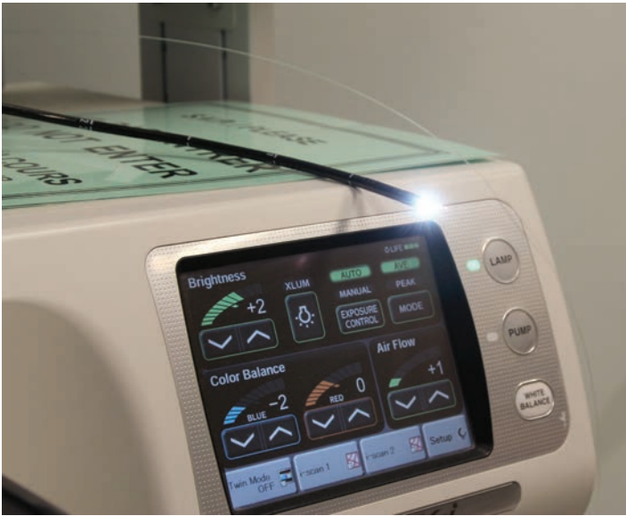
Au bout de l'endoscope se trouve une caméra munie d'une source lumineuse. Un laser ou d'autres instruments peuvent être insérés dans le tube pour effectuer des interventions.
